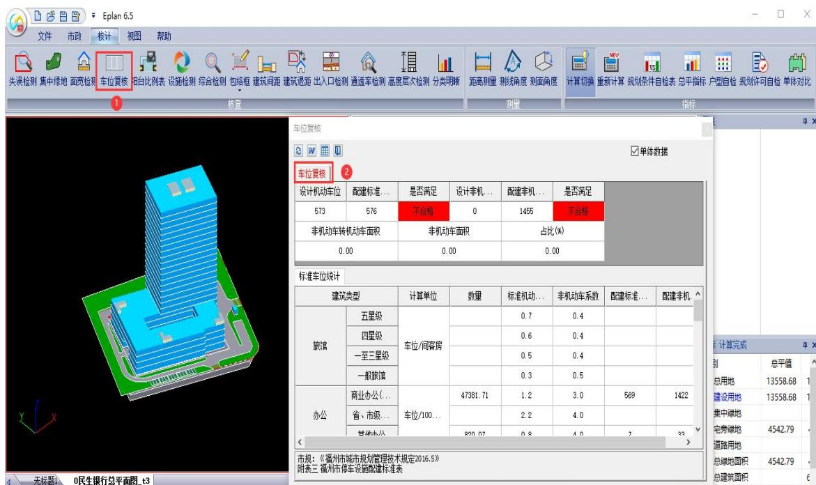
(5) 构件占比表：检测图面上的阳台比例、挑空占比、附属构筑物（0.9A）是否超出控制值。
