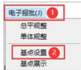
建筑单体平面图，各标准层需要指定基点，用于自动生成模型时对齐。
